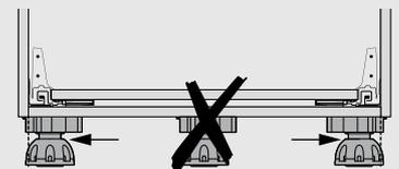
No use amortiguadores, debido a que estos limitan la función de accionamiento. El fondo del cuerpo no debe arquearse hacia arriba, por eso no utilice una quinta base de zócalo.
