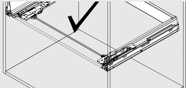
Utilice la varilla de sincronización para un funcionamiento óptimo y una distancia de reacción optimizada de TIP-ON BLUMOTION.
