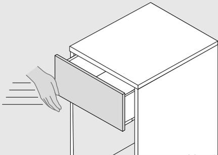
Para tensar el muelle TIP-ON, siempre cierre los módulos extraíbles TIP-ON BLUMOTION con algo de impulso. Cuando los módulos extraíbles están cargados se requiere respectivamente menos impulso.
