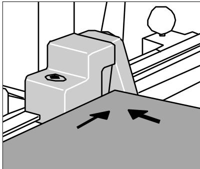
**11. PUSH DOOR AGAINST THE FENCE AND SLIDE UNTIL IT IS POSITIONED AGAINST THE STOP.**
