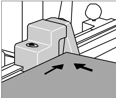
**9. SLIDE CABINET SIDE PANEL AGAINST THE FENCE UNTIL POSITIONED AT THE STOP**
