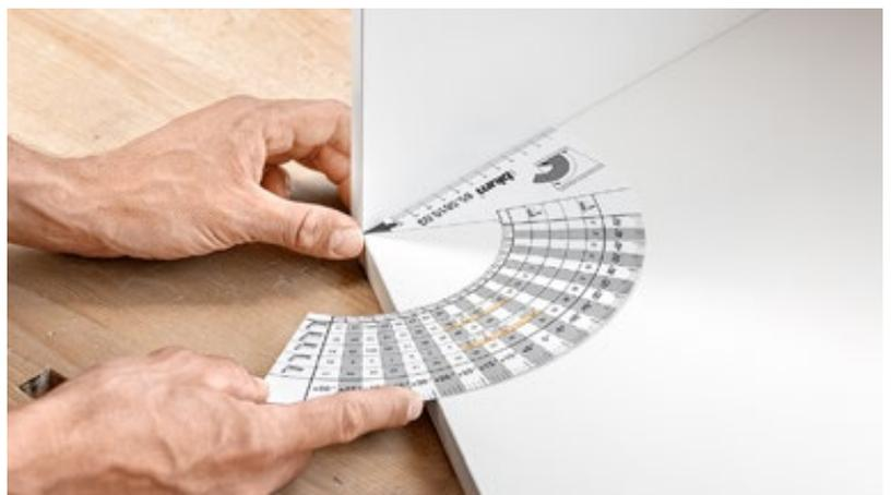
Für die Montage der Fronten haben wir weitere Verarbeitungshilfen im Programm. Zum Beispiel unsere Bohrlehren für Scharniere. Diese sorgen dafür, dass die Bohrpositionen an der Front genau mit denen am Korpus übereinstimmen. So funktionieren die Scharniere optimal: Die Türen schließen schön und das Fugenbild ist makellos.
