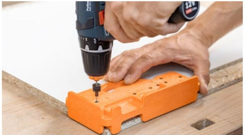
Das Anbringen der Bohrungen ist ein Arbeitsschritt, bei dem es auf höchste Genauigkeit ankommt. Mit unseren Bohrlehren wird auch das Markieren und Vorbohren der Befestigungspositionen für die Korpussschienen zum Kinderspiel. In kürzester Zeit haben Sie die Komponenten für die Montage optimal vorbereitet.
