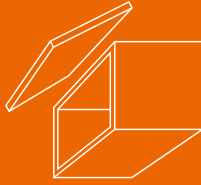
AVENTOS HS für die Hochschwenklappe: einteilige Front schwenkt über den Korpus
