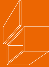
AVENTOS HL für die Hochliftklappe: einteilige Front wird parallel nach oben bewegt
