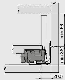
\* +1 mm en cas de montage de la coulisse corps de meuble avant l'assemblage du corps de meuble
