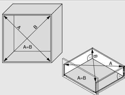
Une production précise est nécessaire pour une jeu de façade de 2.5 mm. Pour cela, respectez les cotes planifiées et l'exactitude des angles.
