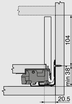
\* + 1 mm en cas de montage de la coulisse corps de meuble avant l'assemblage du corps de meuble
