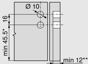
\* + 1 mm en cas de montage de la coulisse corps de meuble avant l'assemblage du corps de meuble
