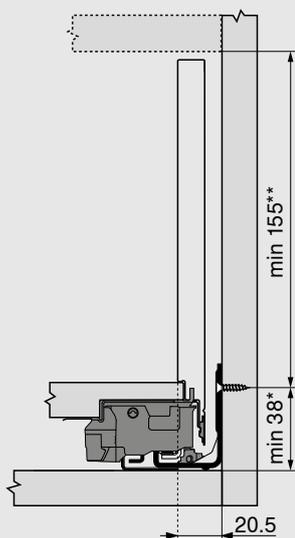
\* + 1 mm en cas de montage de la coulisse corps de meuble avant l'assemblage du corps de meuble
