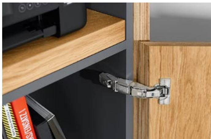
Наши петли 125° с нулевым вхождением предназначены для мебели с внутренними ящиками. Однако они также подходят для различных специальных решений, таких как конструкции со скошенными кромками и с фальцем или с большим наложением фасада до 39 мм.
