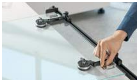
Determinação fácil do posicionamento com o novo gabarito de colagem
