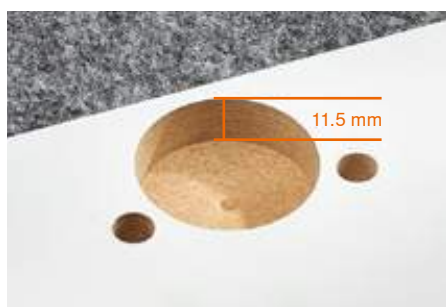
Za posodico odmične spono zadošča globina vrtanja 11.5 mm.
